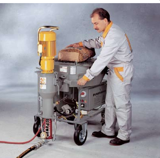
Бункер для материала и смесительная труба находятся отдельно друг от друга. Вы открываете заслонку и сухой материал попадает в смесительную трубу.
